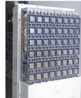
Les antennes massive MIMO sont constituées d'antennes élémentaires plus petites (4 cm à 3,6 GHz, 6 mm à 26 GHz) : antennes typiques de 64, 128, 256 éléments
